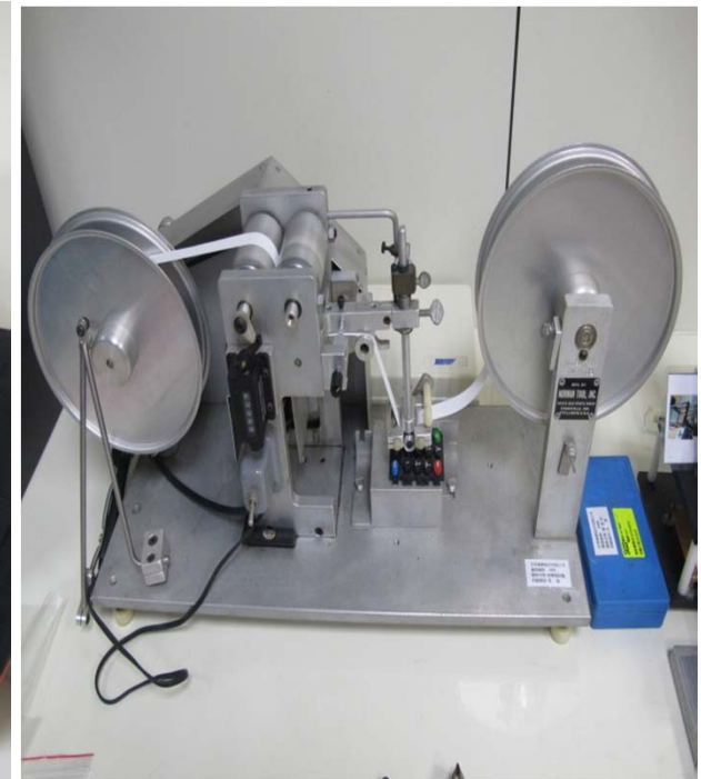
RCA耐磨測試機 檢測印刷或噴漆耐磨度 的機器
