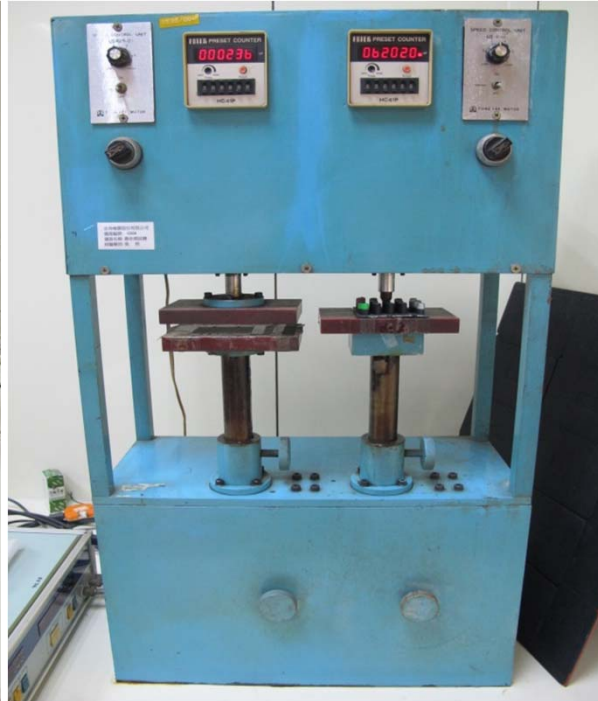
產品壽命測試機 檢測按鍵壽命的機器
