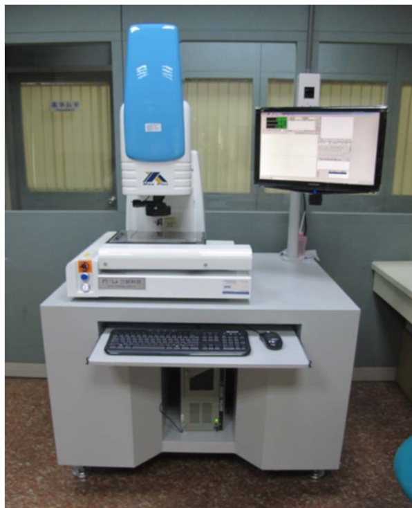
大型2.5D投影顯微機 檢驗外觀與量尺寸的機器
