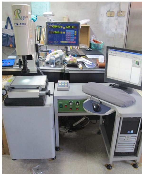
2.5D投影顯微機 檢驗外觀與量尺寸的機器
